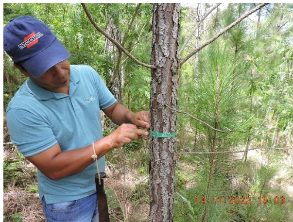
Figura 10. Medição dos diâmetros das plantas a 1,30 m do solo.
