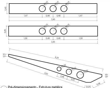
10 Pré-dimensionamento - Estrutura metálica
