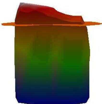
Imagem 01. Modelo tridimensional do volume a ser escavado. A faixa em cor laranja, indica a interface da superfície do terreno.
