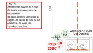
NOTA: Afastamento mínimo de 1,50m de fossos, caixas ou ralos de escoamento de água, gordura, ventilação ou esgoto, de caixas de rede de luz e telefonia, de fossos, de sumidouro e outros.
